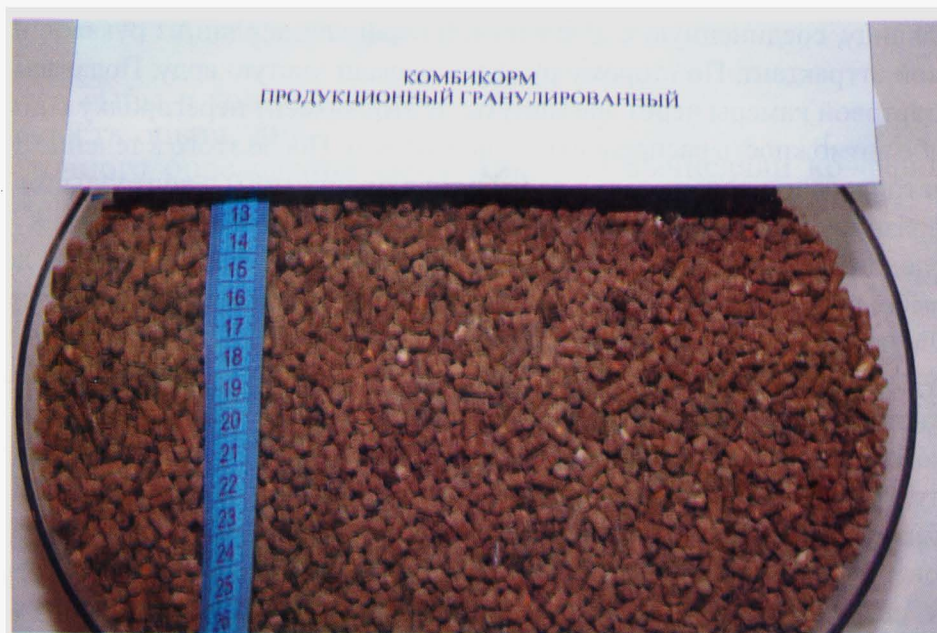
Рис. 65. Гранулы производственного комбикорма. Размер гранул 5–7 мм
